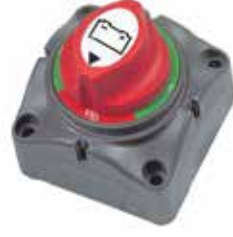
SL 21083 | Akü Şalter ON-OFF Sürekli Akım 200 Amper
