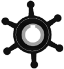
SL48124 | Impeller Lastığı Sealux Çap: 51mm Genişlik: 22mm Kanat Sayısı: 6 Jabsco Kod: 22799-0001
