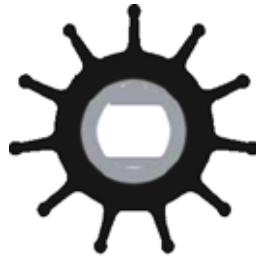
SL 48113 | Impeller Lastığı Sealux Çap: 95mm Genişlik: 88,9mm Kanat Sayısı: 12 Jabsco Kod: 17370-0001
