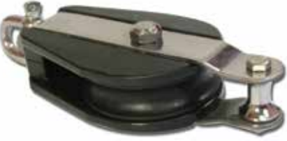
SL16036 Makara Tekli - Kuyruklu 20 mm Min.Çalışma Yüğü:2250kg - Max.Çalışma Yüğü:4500kg
