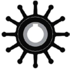
SL48139 | Impeller Lastığı Sealux 9959K(SHERWOOD) Çap: 62mm Genişlik: 31,5mm Kanat Sayısı: 12 Jabsco Kod: 18838-0001
