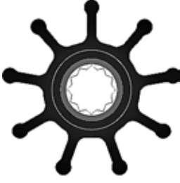
SL48106 | Impeller Lastığı Sealux Çap: 95mm Genişlik: 63mm Kanat Sayısı: 9 Jabsco Kod: 836-0001 836-0003
