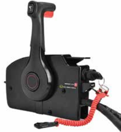
SL11138 | Mercury Kumanda Kolu Yandan Montaj, Marşlı ve Trimli, 14 Pin'li
