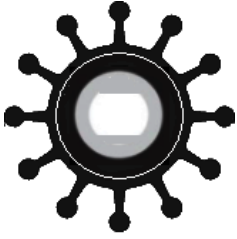
SL48183 | Impeller Lastığı Sealux Çap: 57mm Genişlik: 31,5mm Kanat Sayısı: 12 Jabsco Kod: 14281-0001 14281-0003
